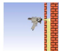
El poliuretano se inyecta en estado líquido en la cámara de aire de la fachada, expandiéndose en el interior y formando una espuma rígida de celda abierta de gran capacidad aislante y muy baja densidad, donde sólo el 2% es materia sólida.
